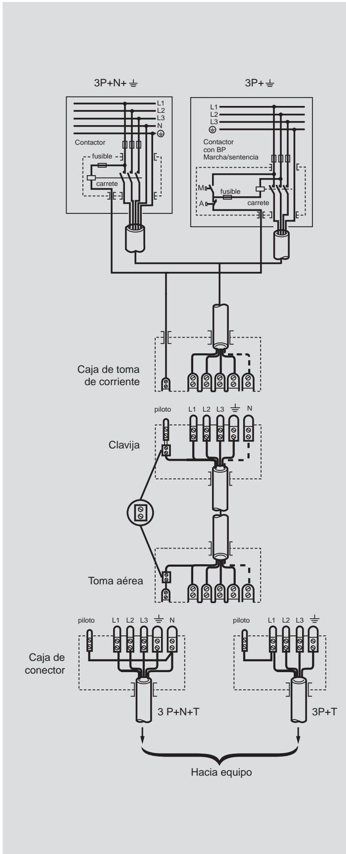
■ Las tomas de esta capacidad cuentan con un pin más corto (pin piloto) que los pines de fase. El pin piloto tiene la opción de ser conectado a un circuito de control (contactor) de manera que al momento de realizar la desconexión de la toma el pin piloto será el primero que deje de conducir abriendo de manera inmediata el contactor de potencia desenergizando el circuito.
