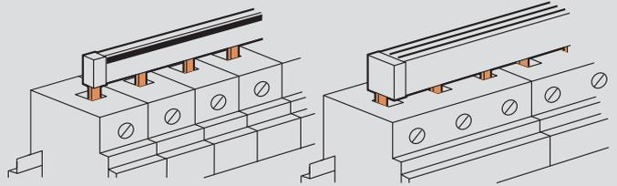
Alimentación por la parte trasera del peine para todos los dispositivos con borne móvil.
